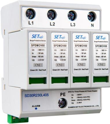
电涌保护器Surge Protection Device (SPD), 也叫防雷器, 是一种为各种电子设备、仪器仪表、通讯线路提供安全防护的电子装置。当电气回路或者通信线路中因为外界的干扰突然产生尖峰电流或者电压时, 电涌保护器 (SPD) 能在极短的时间内导通分流, 从而避免电 (浪) 涌对回路中其他设备的损害。
